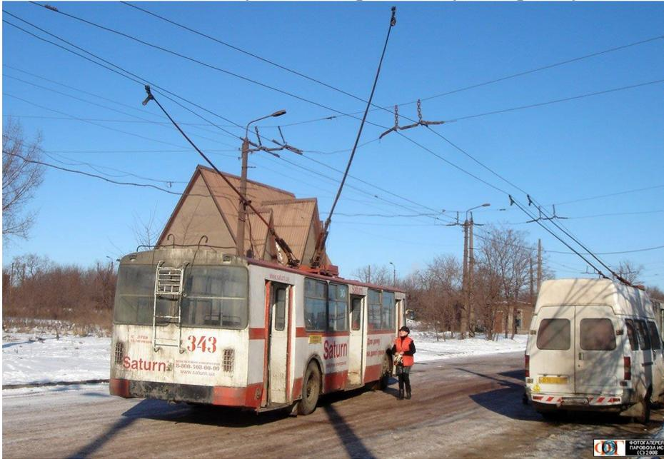
Троллейбусная штанга, прижимаемая роликом к контактному проводу снизу, соскакивает с провода, что ведет к потере контакта. Какое техническое решение поможет устранить эту проблему?
